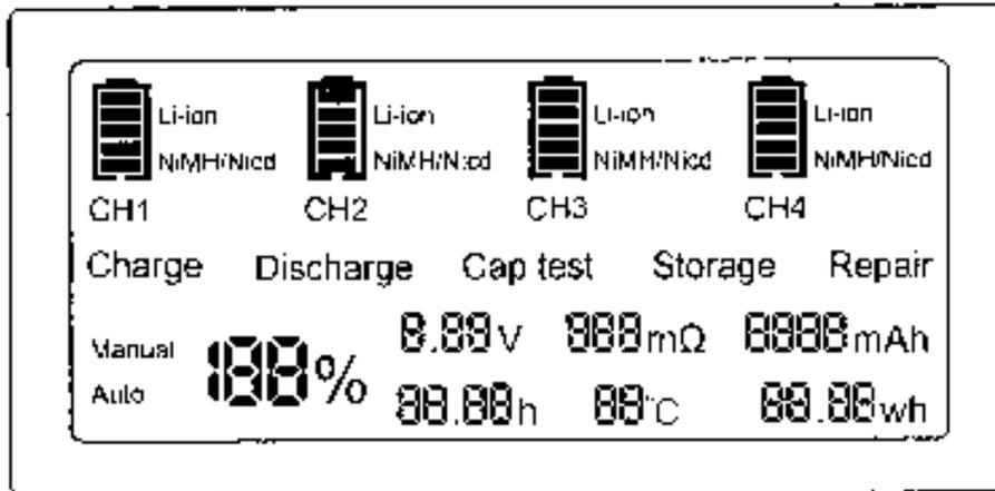
Um die Lebensdauer von Lithium-Ionen-Akkus in der Lagerungsphase zu erhöhen, wurde in der neuen Version 3.0 ein Lagerungsmodus hinzugefügt. Es gibt einen Entlade- und Ladeprozess im Lagermodus. Wenn die Anfangsspannung des Lithium-Ionen-Akkus 3,70 V übersteigt, entlädt er sich auf 3,70 V und stoppt. Wenn die Anfangsspannung des Akkus niedriger als 3,70 V ist, wird er auf 3,70 V geladen.
