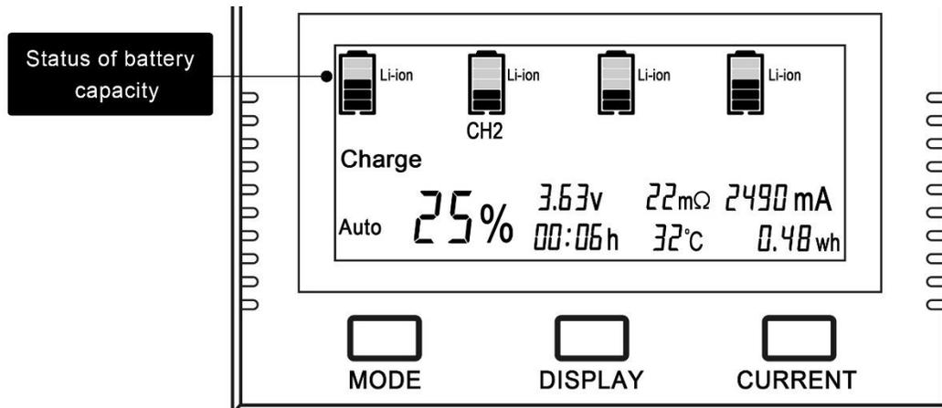
2.7 Wenn mehrere Batterien gleichzeitig in das Ladegerät eingelegt sind, drücken Sie mehrmals die Taste DISPLAY, um die Batteriedaten der einzelnen Ladeschächte nacheinander anzuzeigen. Jeder Steckplatz arbeitet unabhängig, es ist möglich in einem Schacht zu laden, während in den anderen Schächten entladen oder repariert wird, ohne dass die Prozesse sich gegenseitig stören.
