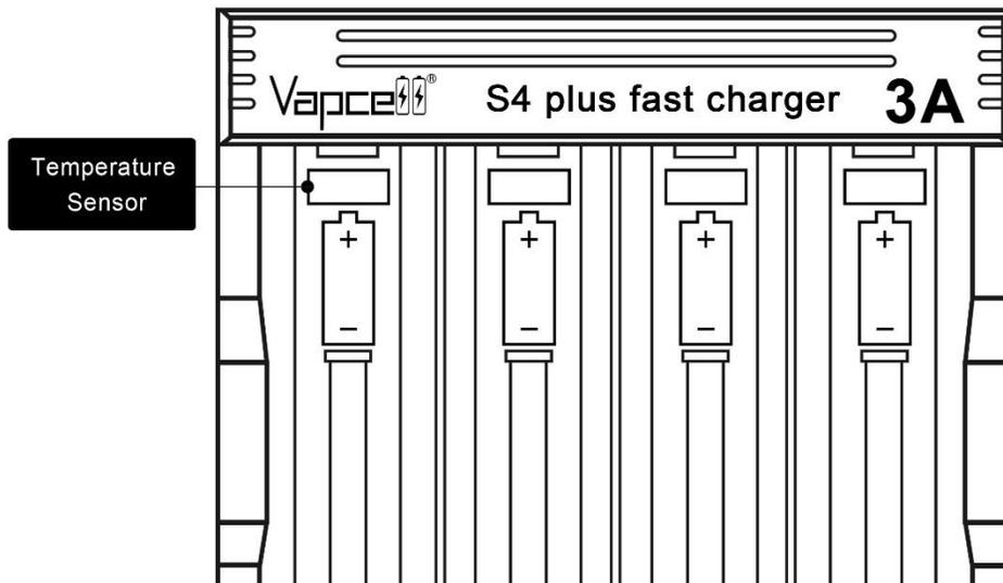
1. Die Temperatur ist höher als 65 °C wenn der Ladestrom höher als 1500 mA ist (ausgenommen 1500 mA), wird er auf 2 Pegel reduziert. Ihr aktueller Ladestrom beträgt beispielsweise 3000 mA und wird automatisch mit 2000 mA aufgeladen.
